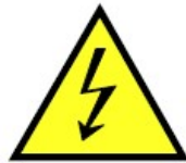
Hình 1 - Cảnh báo nguy hiểm điện áp cao
