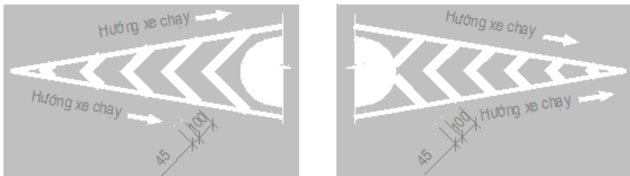
Hình G.28 - Minh họa cách vẽ vạch kênh hóa dòng xe dạng chữ V
