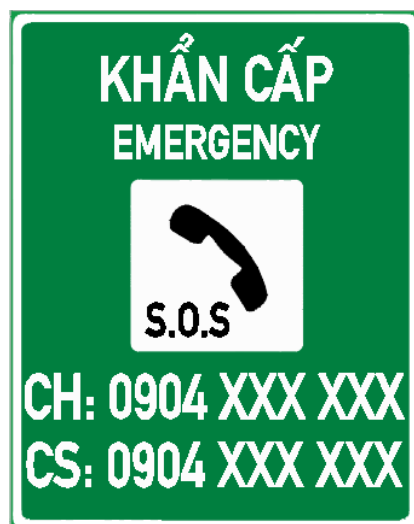
Hình 29 - Biển số IE.470 chỉ dẫn số điện thoại khẩn cấp
