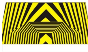
Hình G.63 - Sử dụng vạch 8.1 trên đảo phân làn tại trạm thu phí - Mẫu 1
