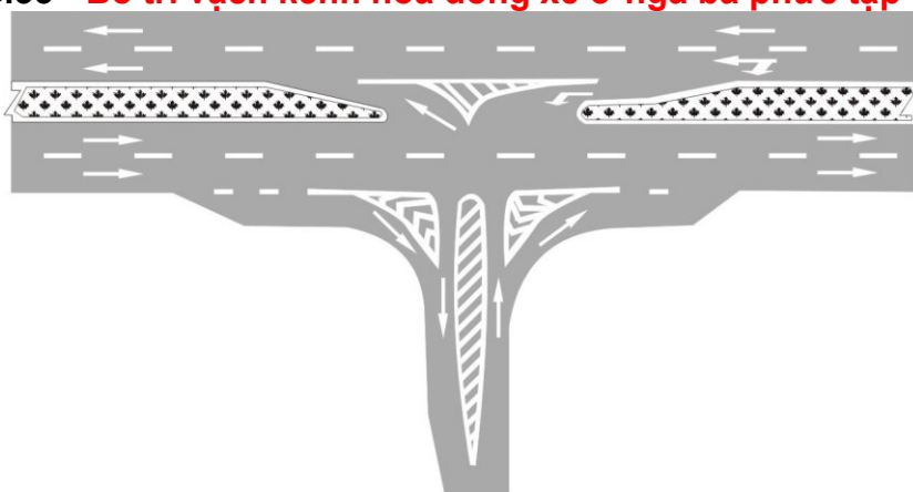
Hình G.34 - Bố trí vạch kênh hóa dòng xe ở ngã ba phức tạp – Mẫu 5
