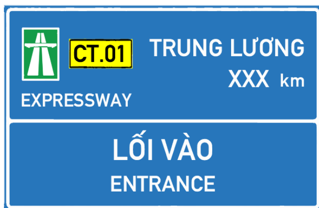
Hình 8 - Biển số IE.451 chỉ dẫn lối vào đường cao tốc
