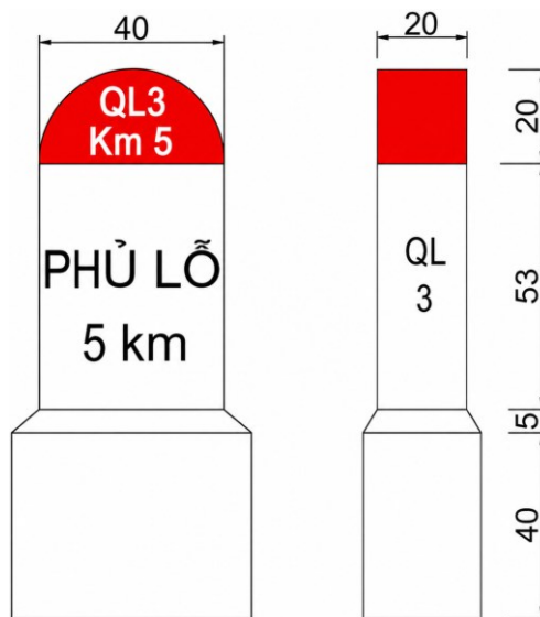
Hình I.1 - Cột kilômét dạng cột thấp
