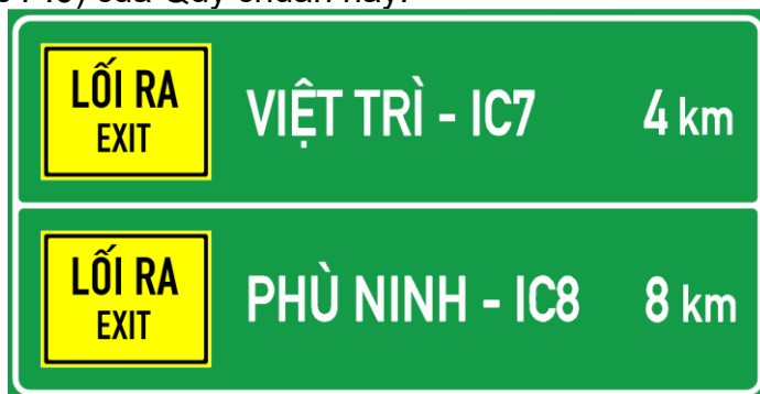
a) Biển chỉ dẫn có hai lối ra tiếp theo
